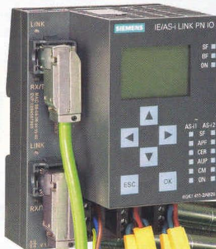
Das Profinet/AS-Interface Link Advanced von Siemens stellt die Anbindung von der Arbeitsvorbereitung bis zur unteren Feldbusebene her; der integrierte Web-Browser bildet das AS-Interface-System ab und liefert einfache Diagnoseinformationen
